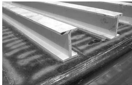
Figura 6.- Detalle de los Conectores de fibra de vidrio AR.
